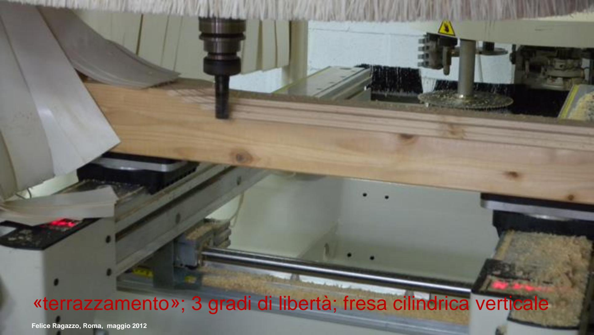
«terrazzamento»; 3 gradi di libertà; fresa cilindrica verticale
