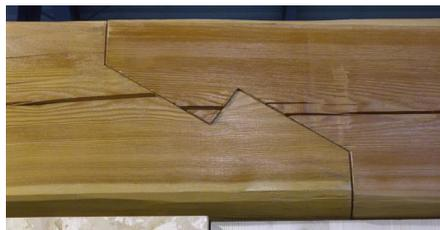
Fig. 32., Relazione tra geometria di giunzione e fisiologia di fessurazione del legno.
