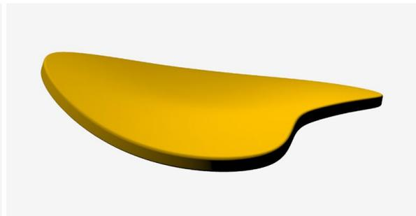
Fig. 29., Smussatura a raggio costante in una membrana bombata.
