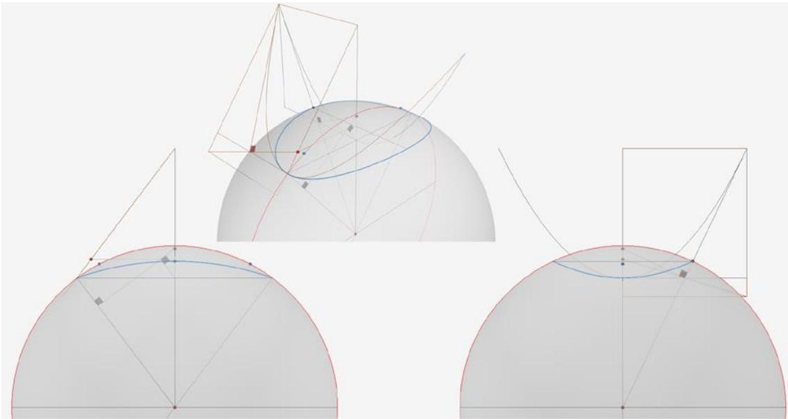
Fig. 11: Grafici relativi alla dimostrazione delle modalità di individuazione del fuoco della parabola generatrice.
