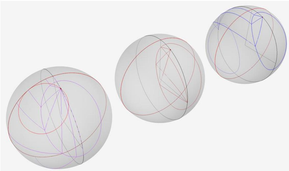
Fig. 2: Il luogo di equidistanza trovato appare come un ellisse, ma possiede le principali proprietà di ciascuna delle tre sezioni coniche. È da osservare il fatto che sia la «parabola» (a sinistra), sia l’«iperbole» (a destra), su sfera sono curve chiuse.
