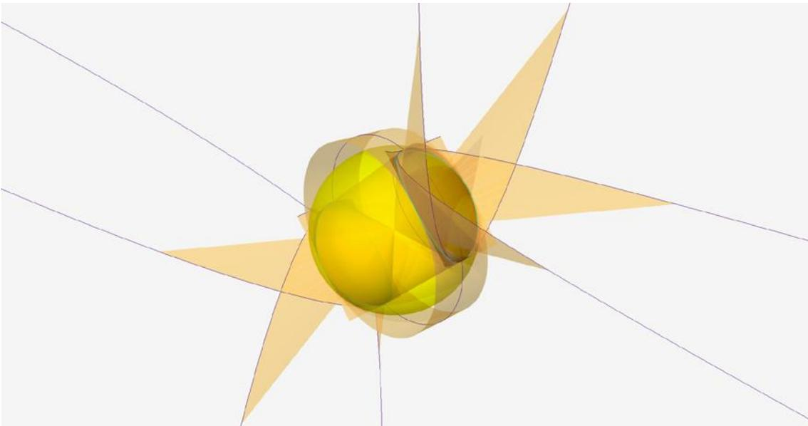
Fig. 3: Intersezione con una sfera dei cilindri ellittici e iperbolico, oltre che del cono parabolico, fungenti da generatori di PalpEll.
