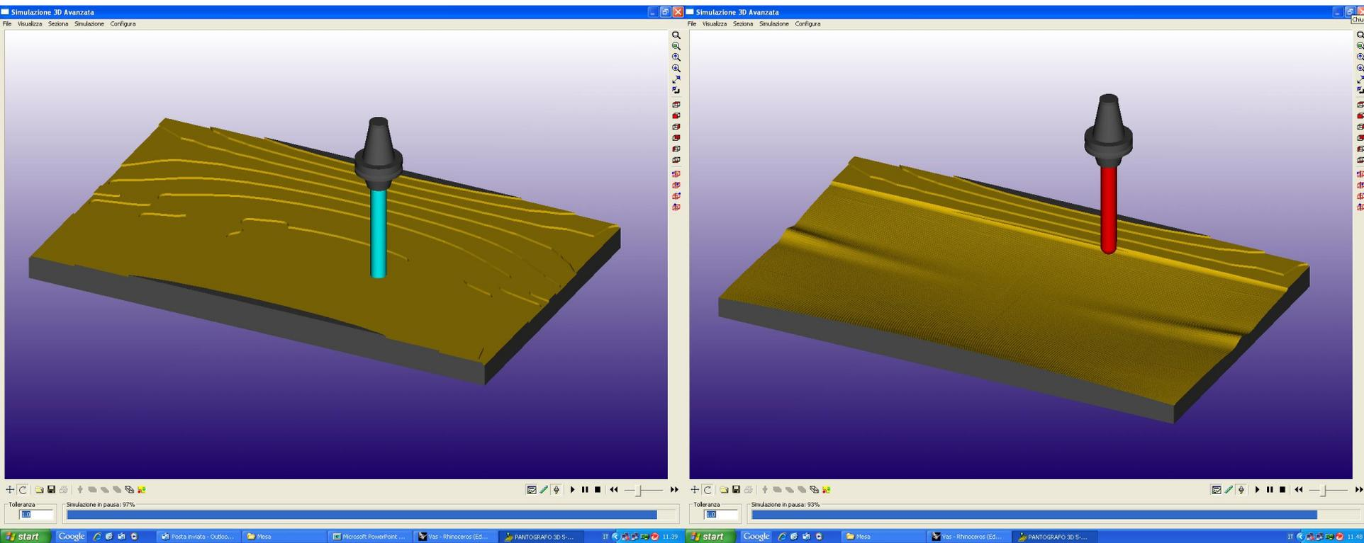
Fresa a cilindro per terrazzare, fresa a sfera, per finire. I solchi sono secondo le isoparametriche.
